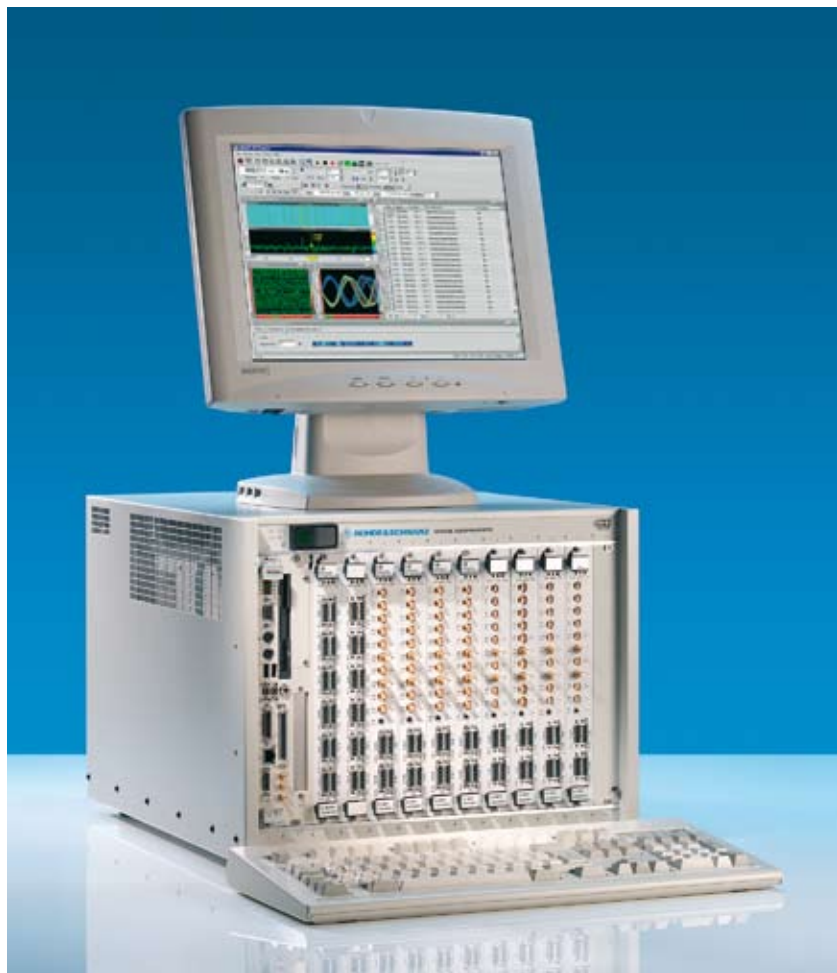
Beispielkonfiguration einer R&S®AMMOS®-Sensorikgruppe (inklusive Steuerrechner) mit R&S®AMMOS®-Fernsteuersoftware, bestehend aus 2 DSP-Boards und 8 HF-Empfängern R&S®EM 010 (voll bestückt)
